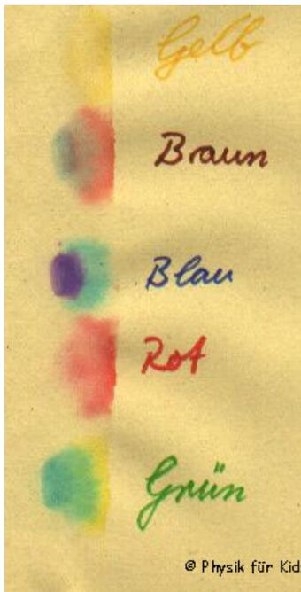
Zuerst malst du auf das Löschpapier mit den Filzstiften, die du untersuchen willst, dicke Punkte - in einer Reihe, etwa 1-2cm vom Rand entfernt. Dann tauchst du das Papier ins Wasser, aber so, dass die Farbpunkte selbst gerade noch über der Wasseroberfläche sind.
